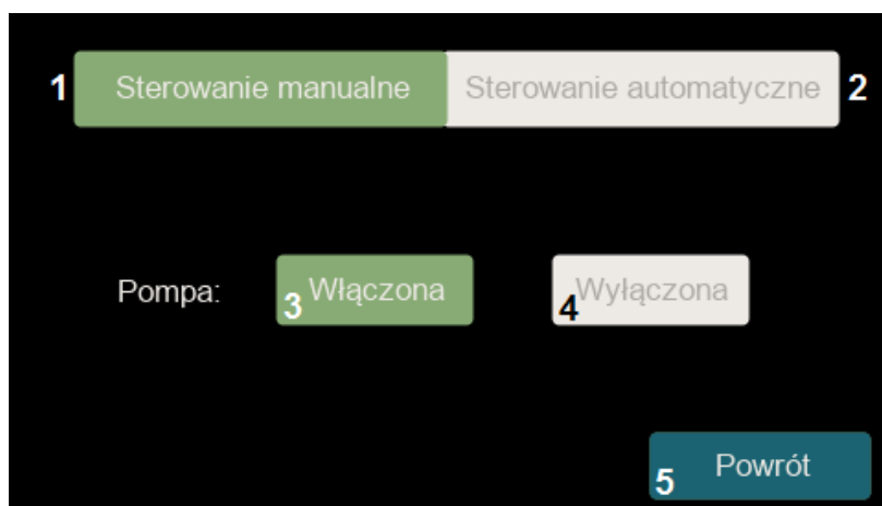
Rys.16 - panel manualny pompy filtracyjnej
