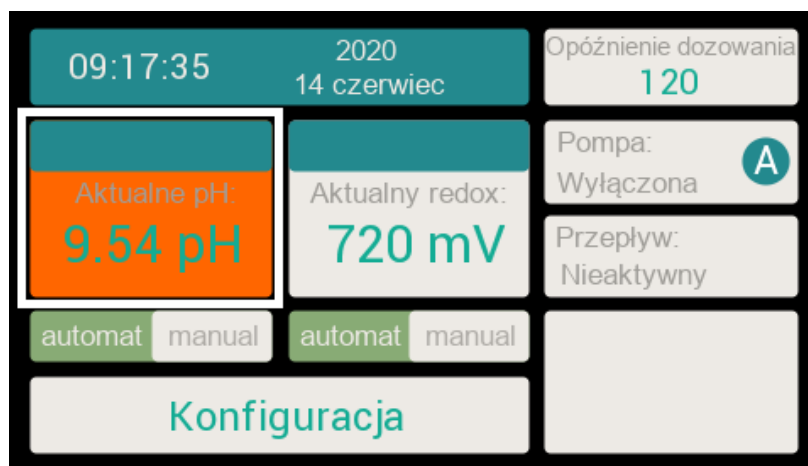
Rys.2 – przekroczony alarm górny pH
